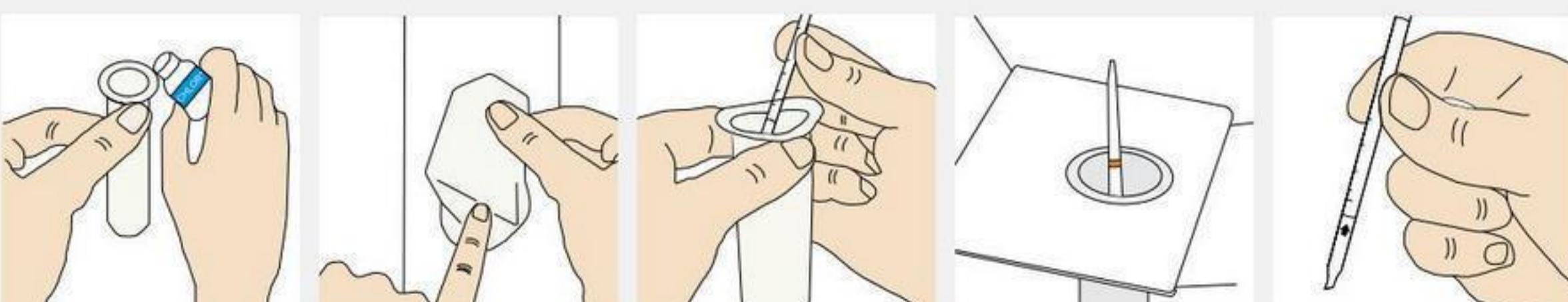
1. 取下CHLOR\*EXTRACT 溶液瓶盖，将整瓶溶液倒入测试套中。
