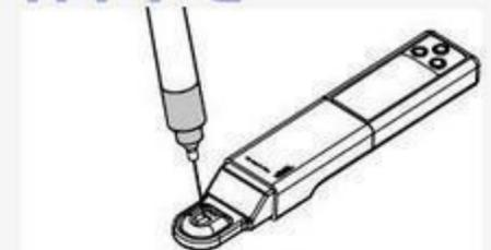
在该期间结束时，尽可能多提取溶液。从贴片拔掉注射器，使用合适的电导率仪例如Elcometer 138来测量溶液中的电导率。
