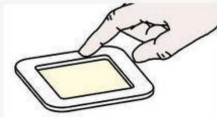
从盐分贴片中心，取出保护包装和泡沫。在表面贴上盐分贴片，紧压边缘，实现完全密封—确保测试舱中有最少的空气。
