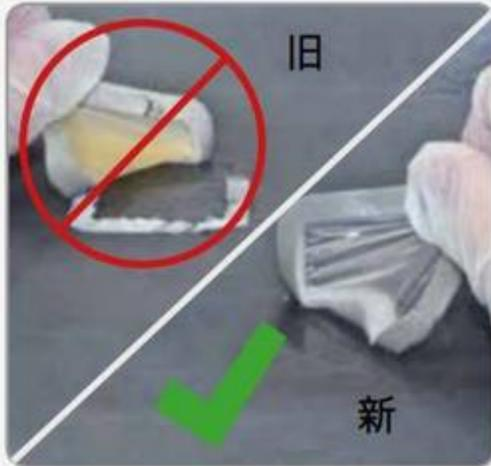
Elcometer 135C Bresle 测试贴片测试以后易剥离, 不留下任何泡棉在基板上, 因为没有需要刮掉残留物, 减少损害。
