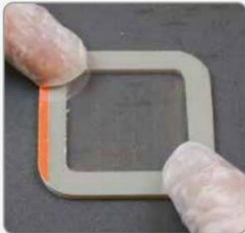
坚固耐用新的 Elcometer 135C Bresle贴片使用高品质粘合剂, 确保测试期间不漏水的密封。
