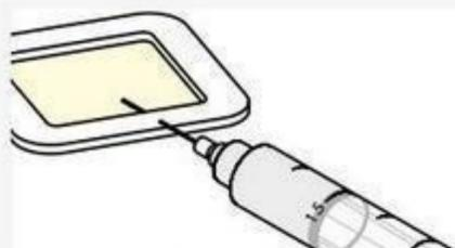
用3ml纯水填入注射器。通过海绵泡棉周长以大约30°到测试面的角度，将注射器插入贴片，使其穿过泡棉到测试的贴片。
