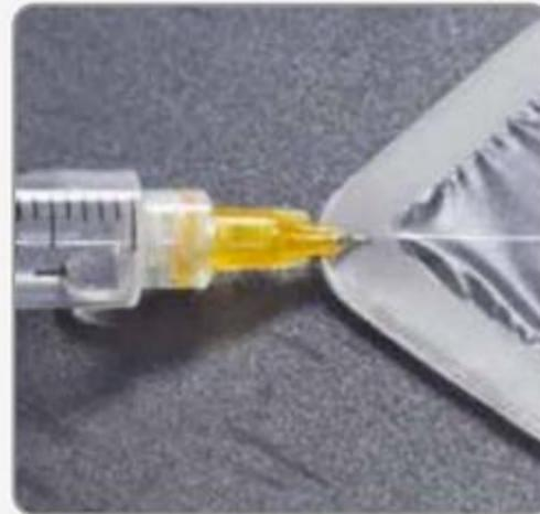
新的Elcometer 135C Bresle测试贴片有一个相对于传统贴片四周较厚的泡棉, 从而允许注射器更容易地插入。
