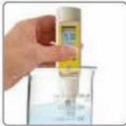
掺入一个杯式传感器，Elcometer 138E电导率计可以从几滴样品测量溶液的电导率。
