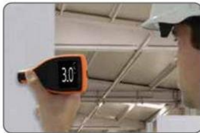
360°自动旋转显示屏, 在任何角度测量, 显示一个清晰读数, 在生产线上或QA站。
