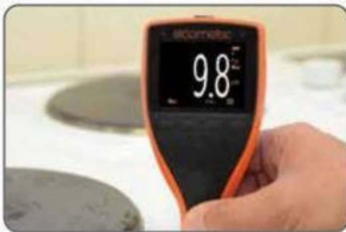
适用于在较薄涂层基板测量干膜厚度。
