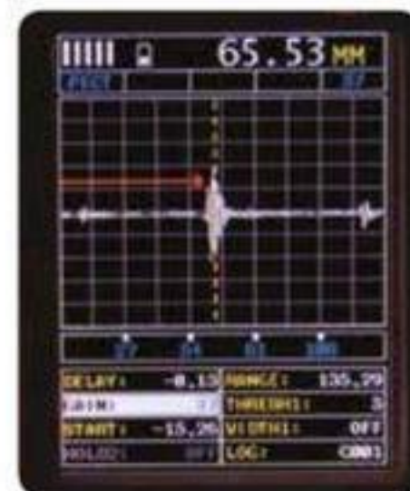
PECT 脉冲-回波涂层模式 同时显示材料厚度 ( PE ) 和涂层厚度(CT)。
