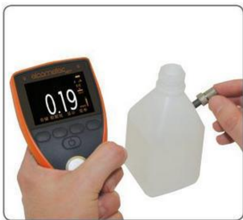
超声波测厚仪PTG系列的精确度是±1%，从0.15mm (0.006")至25.40mm(1.000")。
