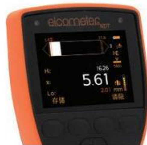
在扫描模式中仪器在16Hz的速率采取读数(每秒16个读数)。
