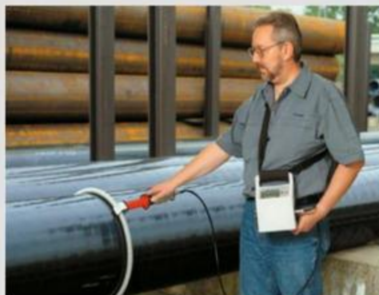
管道孔隙率检测
